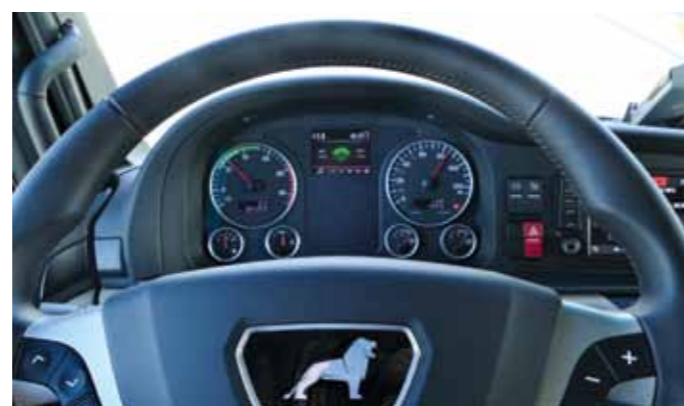
Pri 85 km/h se motor vrti s 1.150 vrt./min., na voljo je tudi štiristopenjski ECO način vožnje.
