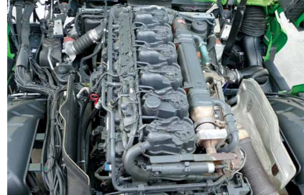
Vžigalne svečke na motorju na plinski pogon niso vidne, ker so skrite pod pokrovi s po dvema vijakoma, vidni pa so kabli.
