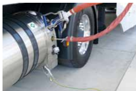
Zgornji priključek je za polnjenje s plinom, srednji za odvajanje iztisnjenega zraka, spodaj je žica za ozemljitev.
