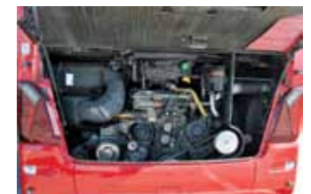
Največji avtobus na testu je bil opremljen z najmočnejšim motorjem z močjo 375 kW/510 KM.
