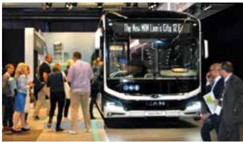
MAN Lion's City 12 E ima vse baterije nameščene na strehi avtobusa, zato je notranjost namenjena zgolj prevozu potnikov.
