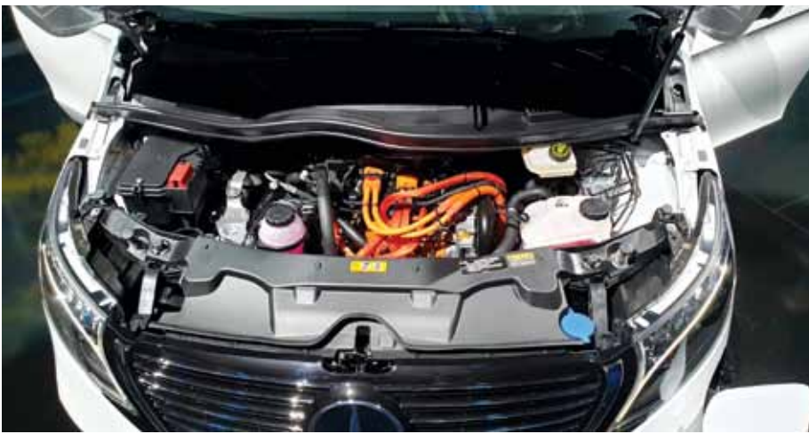
»Električni V« s pogonom na sprednji kolesni par poganja kompaktni električni pogon (eATS) z močjo 150 kW, ki je nameščen na sprednji osi.
