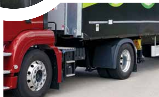
Pogonske osi imajo različna prenosna razmerja (2,71 in 4,00).
