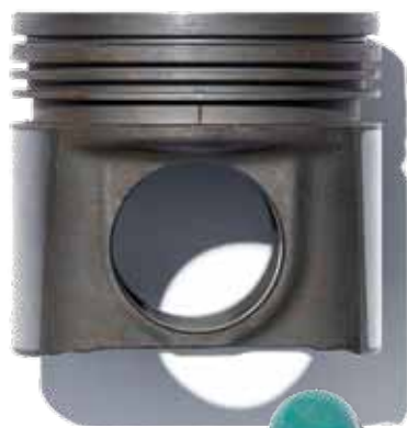
Dobro obrabljen bat D16 730 KM motorja, ki ga je legendarni predelovalec tovornjakov Svempas predelal na več kot 2000 KM.
