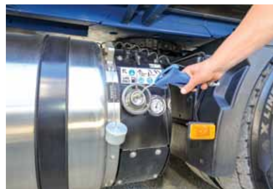
Za čiščenje polnilnega priključka je na okvir pritrjena pnevmatska pištola.
