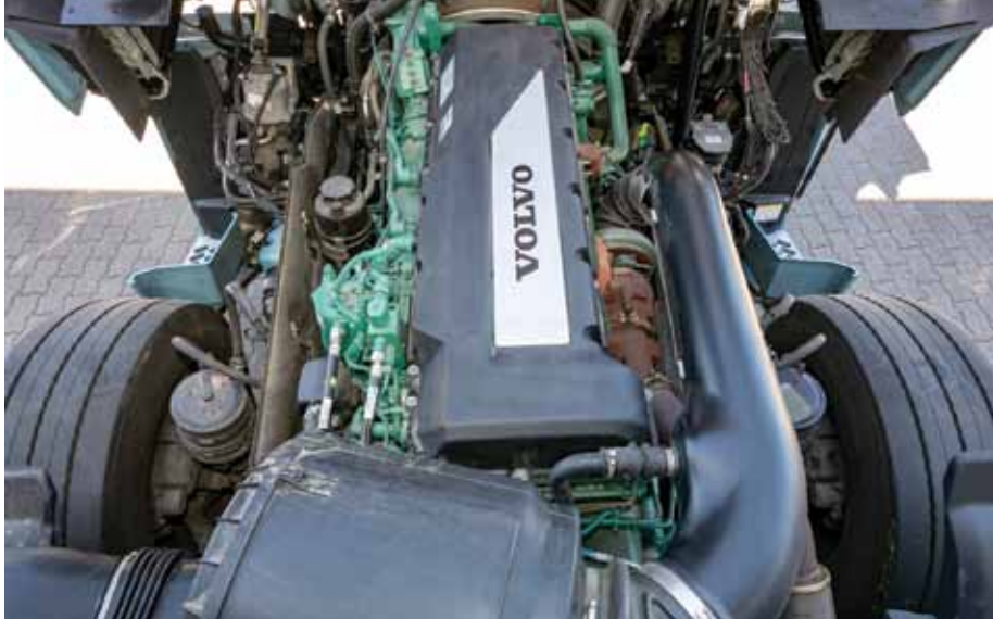
Osnova motorja ustreza različici D13, plinski modul je nameščen na na levi strani.
