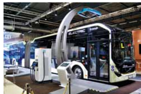
Električni zglobni avtobus Volvo 7900, ki ga preizkušajo v Göteborgu, je privlačnega dizajna. Meri 18,64 metra in lahko prevaža do 135 potnikov. Energija se skladišči v Akasol NMC baterijah.
