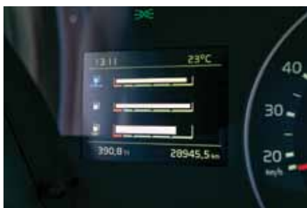
Računalnik vozila preko zaslona obvešča o različnih nivojih polnosti rezervoarjev za LNG, dizelsko gorivo in Adblue ...
