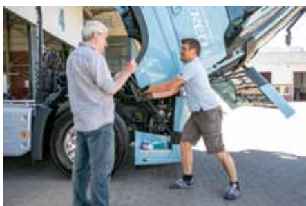
Testno vozilo ni imelo vgrajenega električnega dviznega mehanizma kabine. Ta je opcijsko na voljo tudi za FH LNG.
