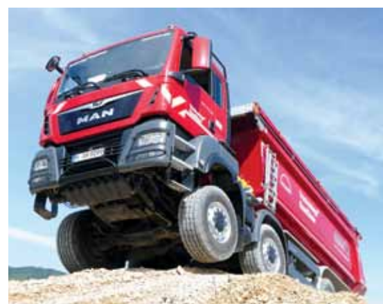
TGS 41.500 8x8 BB predstavlja najvišjo raven oprijema pri tovrstnih tovornjakih – terenska klasika s številnimi mehanskimi in elektronskimi pripomočki.
