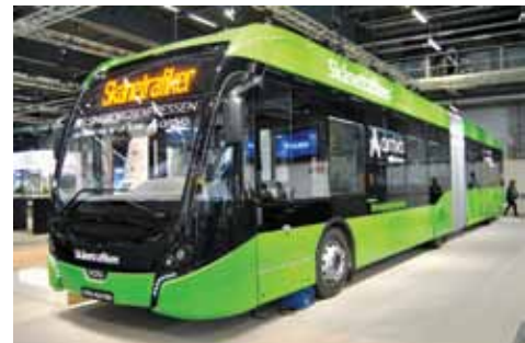
VDL je predstavil model Citea SLFA-181 Electric s BRT dizajnom, opremljen s 169 kWh baterijami in pantografom.
