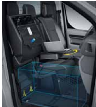
Flex-Cargo sistem dvigovanja sovoznikovega sedeža omogoča prevažanje predmetov do dolžine 4,02 metra.
