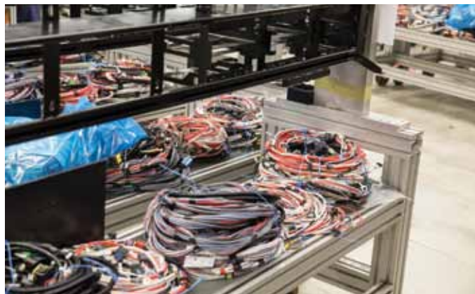
Žice in kablji, pripravljeni za vgradnjo v vozilo, tehtajo 150 kilogramov.
