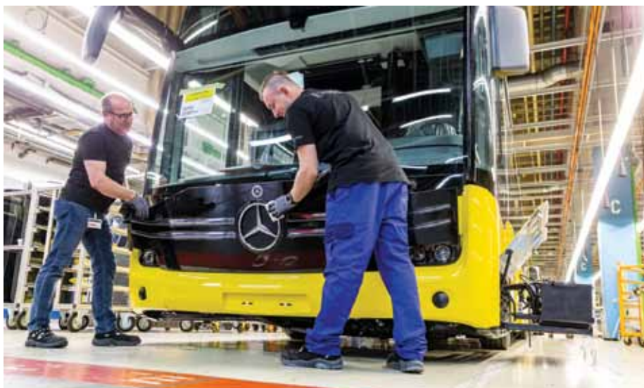
Namestitev sprednje maske, kjer seveda prevladuje Mercedesova zvezda.
