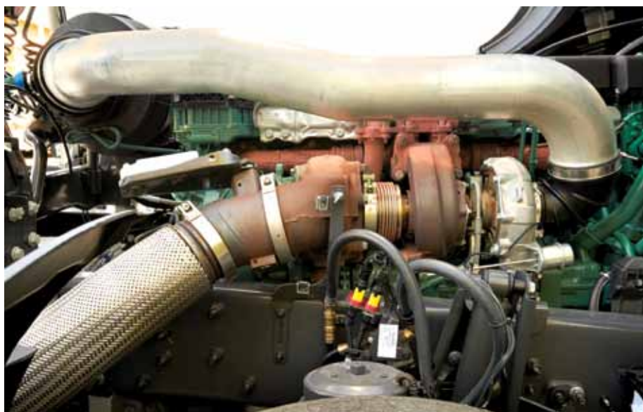
Za običajnim turbinskim polnilcem je pri TC še ena turbina.
