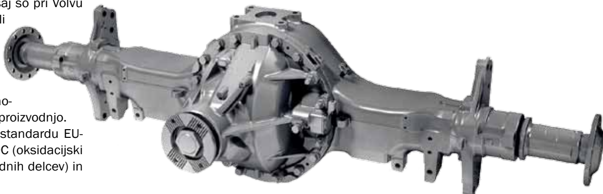
Nova pogonska os je 100 kg lažja in na voljo z različnimi prenosnimi razmerji.
