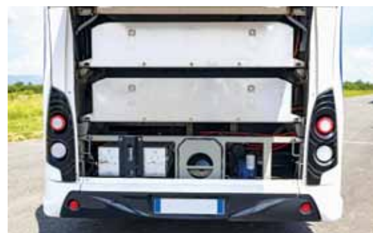
Da bi se olajšalo delo v servisnih delavnicah, ima GX Elec enostaven dostop do električnih komponent.
