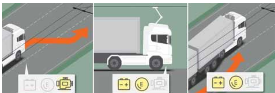
Takole v treh korakih izgleda priklap, vožnja in odhod vozila iz električne ceste
