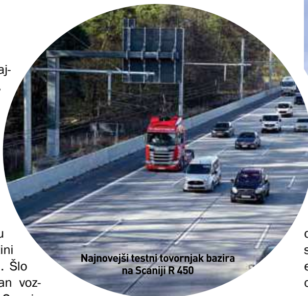
Nad kabino nameščen odjemnik električnega toka je v sklopu projekta razvilo podjetje Siemens
