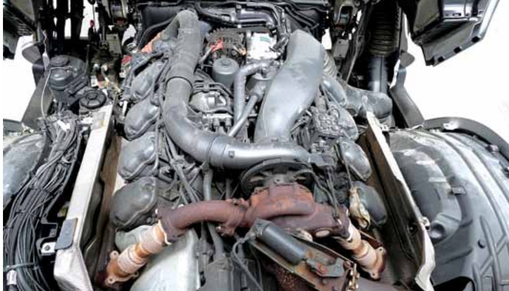
Motor s pomožnimi agregati zapolni ves prostor pod kabino.
