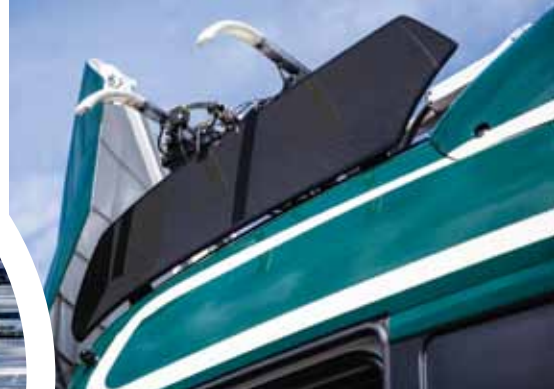
Nad kabino nameščen odjemnik električnega toka je v sklopu projekta razvilo podjetje Siemens
