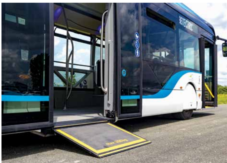
Dostop v notranjost avtobusa je zaradi rampe omogočen tudi za gibalno ovirane osebe.
