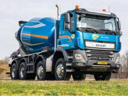
DAF CF 450 FAD 8x4 betonski mešalec. Poleg 7,5- ter 8- in 9-tonske prednje osi ponuja DAF tudi novo prednjo os nosilnosti 10 ton.
