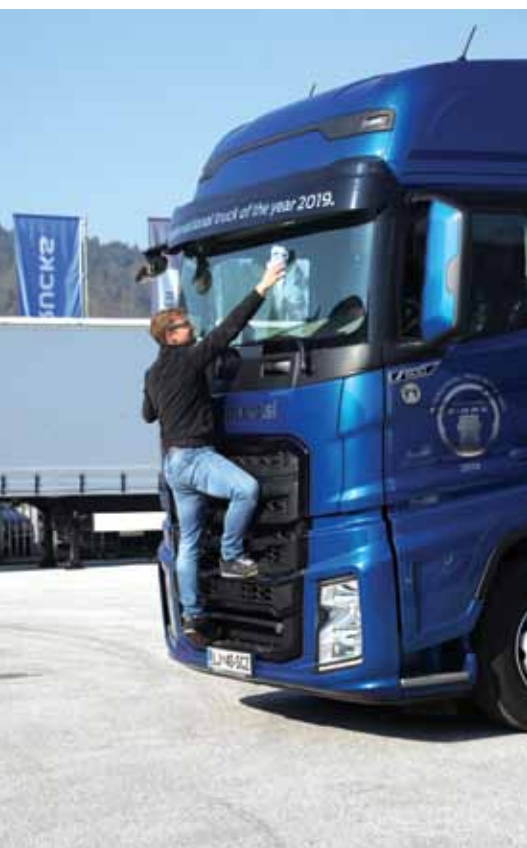
V maski sta »skriti« dve stopnici, ki vozniku omogočata dostop do vetrobrana.
