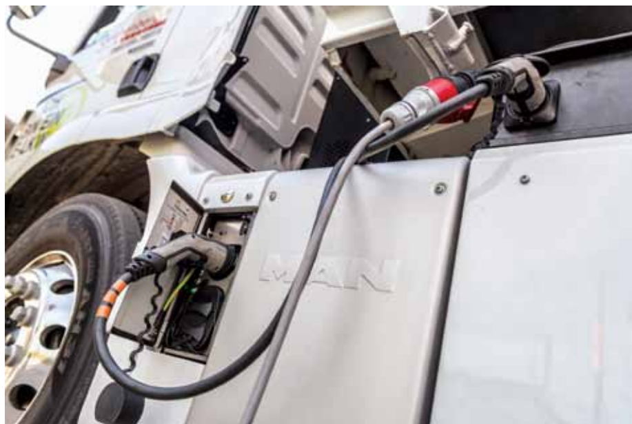
Praktična rešitev – dokler ni postavljena stalna polnilna postaja na lokaciji e-tovornjaka, so v uporabi mobilni polnilniki, ki omogočajo polnjenje s konvencionalno visokonapetostno vtičnico.
