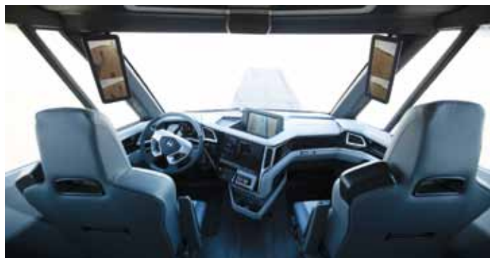
Vsi Nikolovi tovornjaki prihodnosti imajo digitalni kokpit, Bosch je prispeval sistem kamer namesto vzratnih ogledal, velik 17-palčni informacijski zaslon pa skrbi za vso logistiko.
