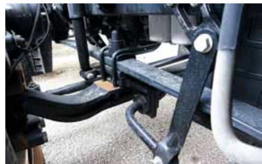
Prednja prema je podprta z enolistnima paraboličnima vzmetema in dodatno vodena s prečnim stabilizatorjem.
