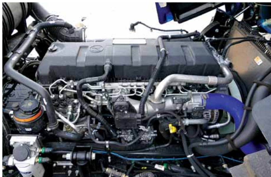
Motor deluje tiho, je dovolj močan in nudi visok navor, motorna zavora pa zmore moč 400 kW.
