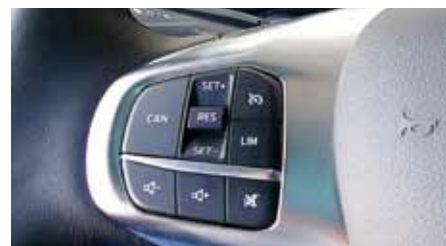
Na levi strani volana je garnitura gumbov za upravljanje tempomata.
