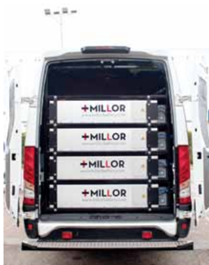
V zadku vozila so nameščene 4 NMC baterije s kapaciteto 108 kWh, kar je dovolj za 10-12 delovnih ur in domet do 166 km v idealnih razmerah.
