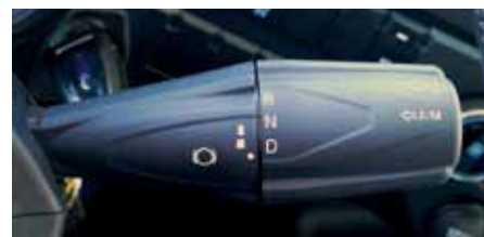
Z desno obvolansko ročico izbiramo smer vožnje, lahko ročno pretikamo in zaviramo z motorno zavoro.
