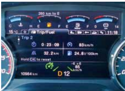
Prikaz na armaturni plošči voznik prilagaja svojim potrebam. Na spodnjem delu vidimo, da je tempomat nastavljen na 85 +/- 6 km/h in da je menjalnik v 12. prestavi.
