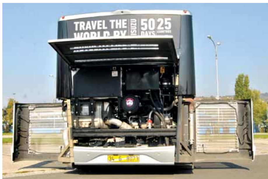
Poganja ga Iveco Euro 6 motor moči 186 KM, v kombinaciji z avtomatskim Allison menjalnikom z retarderjem.
