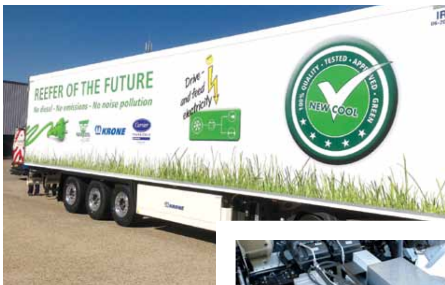
Prikolica New Cool ob zaviranju proizvaja energijo in jo skladišči v ločenih baterijah.
