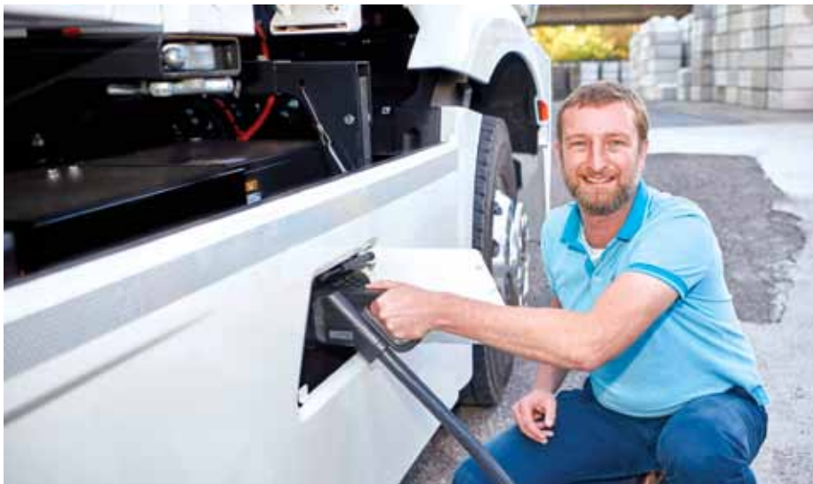
Baterije v eActrosu se polnijo tudi med nakladanjem in razkladanjem, tako da bo dnevno možno prevoziti tudi do 200 kilometrov.
