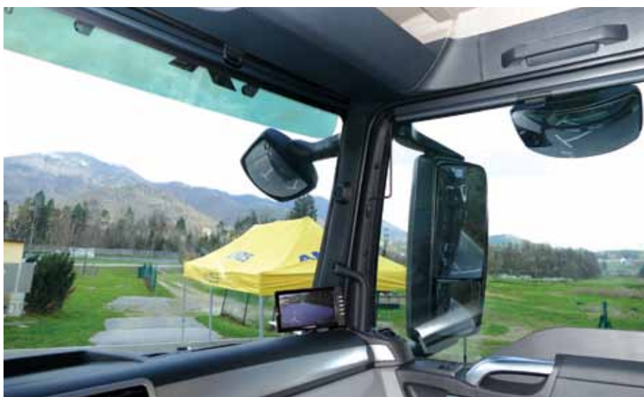
Za popolno preglednost ob vzvratni kameri poskrbi serija ogledal, na levem boku pa je nameščena še kamera, katere zaslon je na stebričku A.
