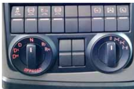
Z levim okroglim stikalom izbiramo režim delovanja menjalnika, z desnim način pogona in vključevanje zapor, zgornji pa vključujejo podporne sisteme (terenski ABS, zibanje, volansko zavoro ...).
