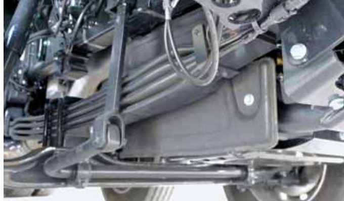
Prednji premi sta podprti s štirilistnimi paraboličnimi vzmetmi.
