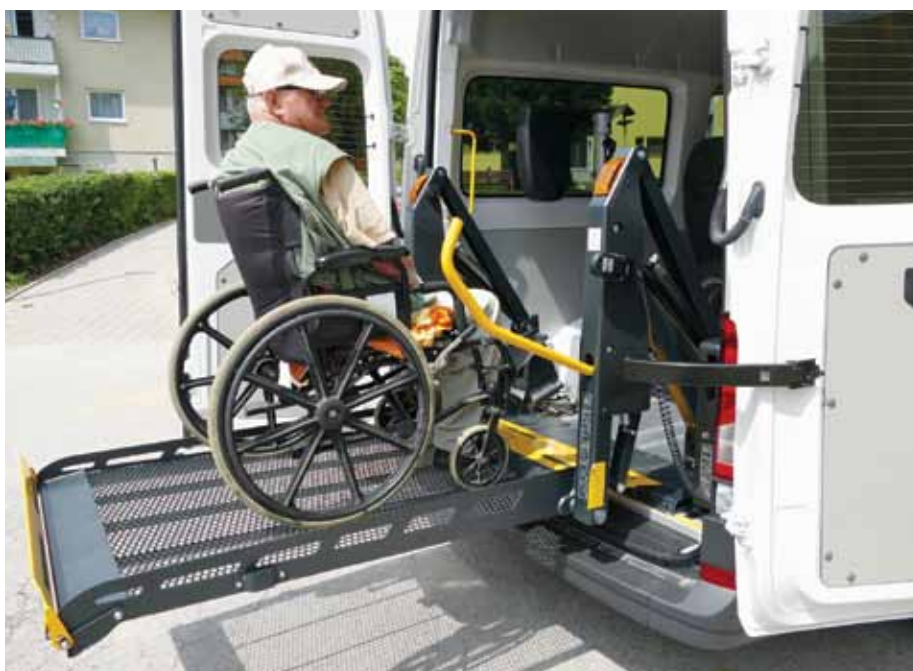
Dvižna ploščad z nosilnostjo 350 kg je enostavna za upravljanje.
