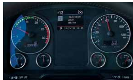
V položaju D avtomatika pri 60 km/h in 950 motornih vrtljajih vozi v 12. prestavi.
