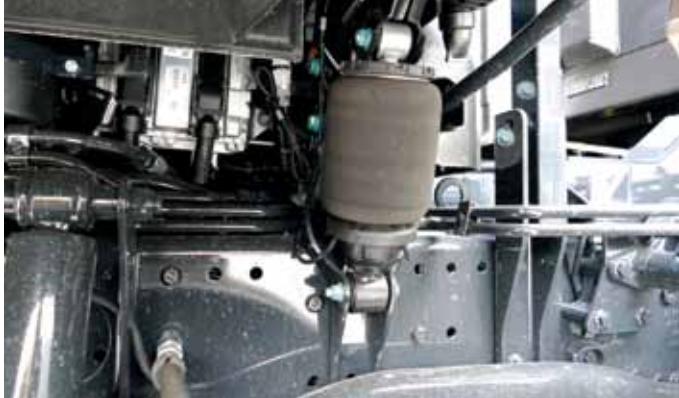
Kabino z okvirom povezujejo štiri zračno vzmetene noge.
