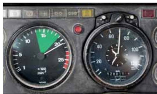
Pri 70 km/h motor hrumi pri 2.100 vrtljajih v minuti.
