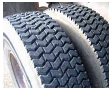
Na pogonski osi so vedno obnovljene gume z zimskim profilom.
