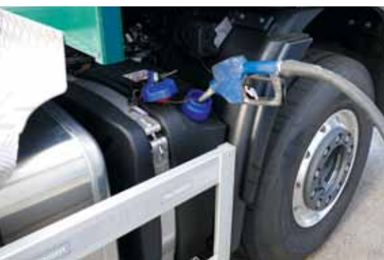
Rezervoarja AdBlue in plinskega olja sta zavarovana z okvirjem.
