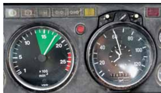
Pri 60 km/h so motorni vrtljaji že blizu zgornjega roba zelenega polja.
