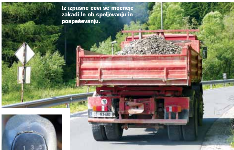
Menjalnik ima šest prestav s polovičkami in shema pretikanja ni več zrcalna.
