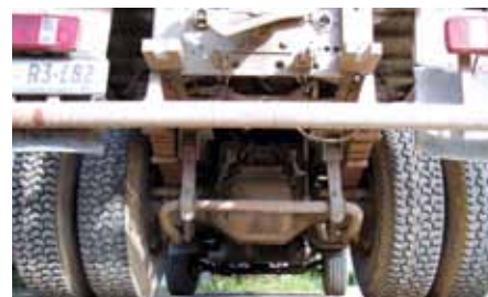
Na pogonski osi so vedno obnovljene gume z zimskim profilom.
