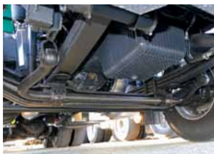
Prednja prema je vzmetena s trojno parabolično vzmetjo, na terenu pa se je potrebno zavedati, da oljno korito ni zaščiteno.
