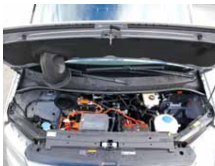
Elektromotor razvije maksimalno 100 kW moči in 290 Nm navora.
