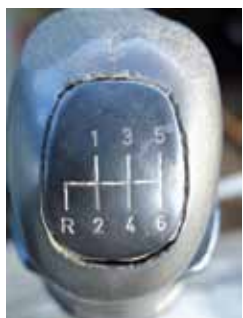
Menjalnik ima šest prestav s polovičkami in shema pretikanja ni več zrcalna.
