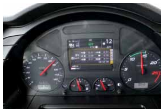
Pri hitrosti 85 km/h merilec kaže malo manj kot 1.400 vrtljajev na minuto.
