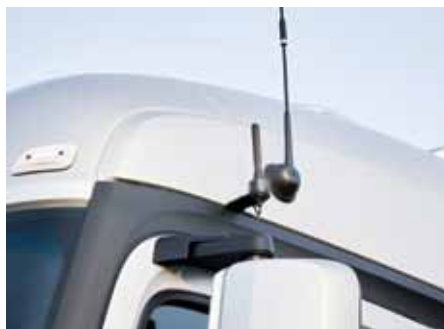
Komunikacija s cestno infrastrukturo poteka preko Wi-Fi povezave, ki deluje do razdalje 500 metrov.
