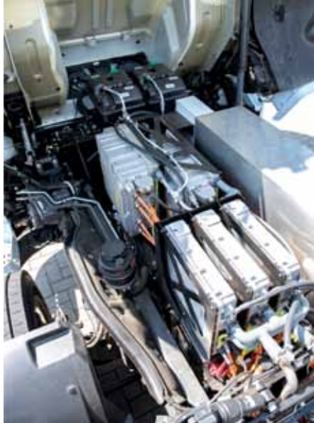
Motor energijo pridobiva iz litij-ionskih baterijskih blokov kapacitete 170 kW.
