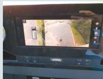
Sprinter je opremljen z več kamerami, ki pokrivajo okolico 360°.
