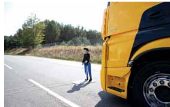
V primeru, da sistem zazna možnost trčenja v pred nami vozeče vozilo ali da bi pešec prečkal vozišče, sistem naprej optično in akustično opozori voznika, nato zavira z vso močjo.
