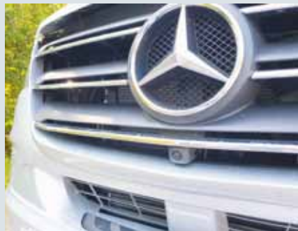
Sprinter je opremljen z več kamerami, ki pokrivajo okolico 360°.
