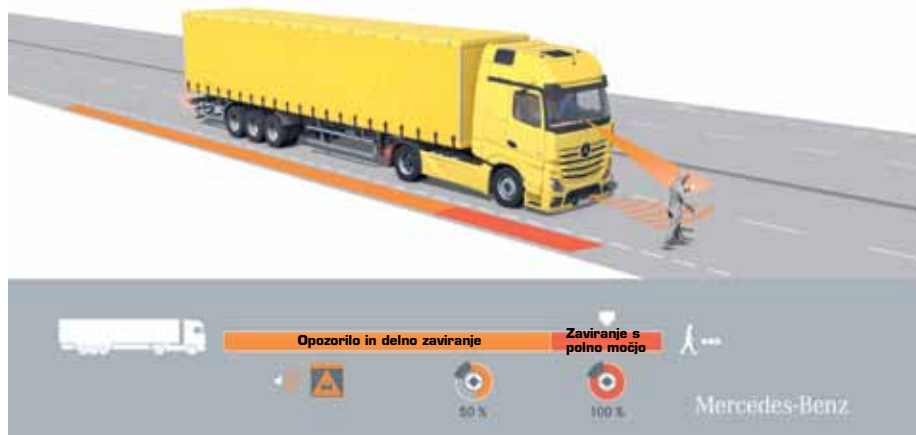
V primeru, da sistem zazna možnost trčenja v pred nami vozeče vozilo ali da bi pešec prečkal vozišče, sistem naprej optično in akustično opozori voznika, nato zavira z vso močjo.
