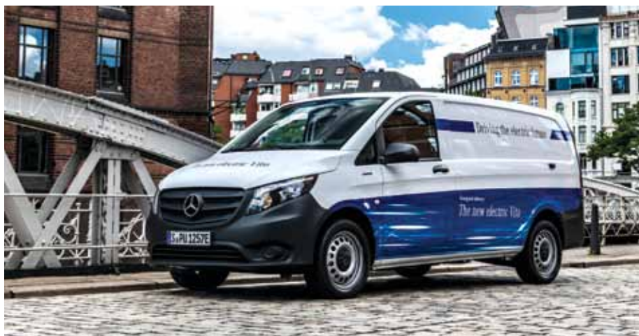
Srce vozila predstavlja elektromotor moči 84 kW z 300 Nm navora, vozilo razvije hitrost do 80 km/h.
