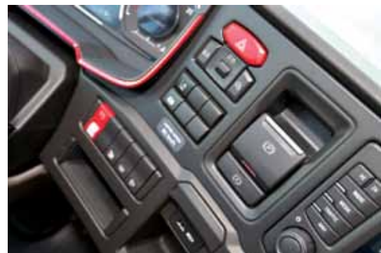
Elektropnevmatska parkirna zavora se nahaja na armaturni plošči.
