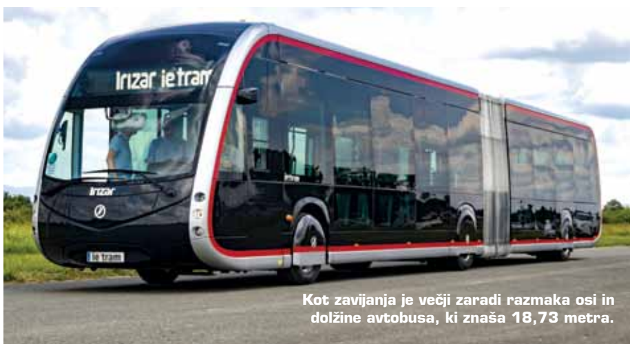
Namesto zunanjih vzratnih ogledal so levo in desno nameščene kamere.
