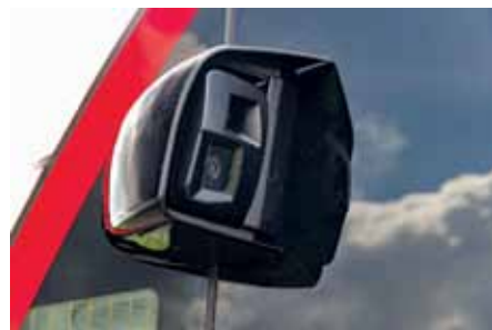
Namesto zunanjih vzratnih ogledal so levo in desno nameščene kamere.
