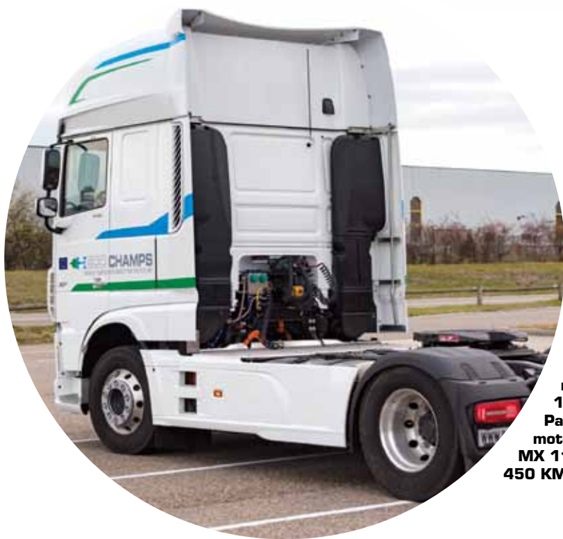
Speljevanje tovornega vozila z mesta v osnovi poteka vedno z električnim motorjem.
