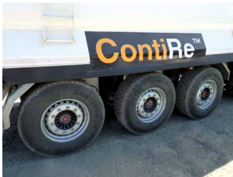
Na prikolici so obnovljene pnevmatike ContiRe s toplo obnovo.
