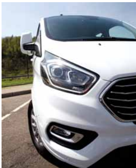
Sprednji žarometi z dnevnimi lučmi v LED tehnologiji.
