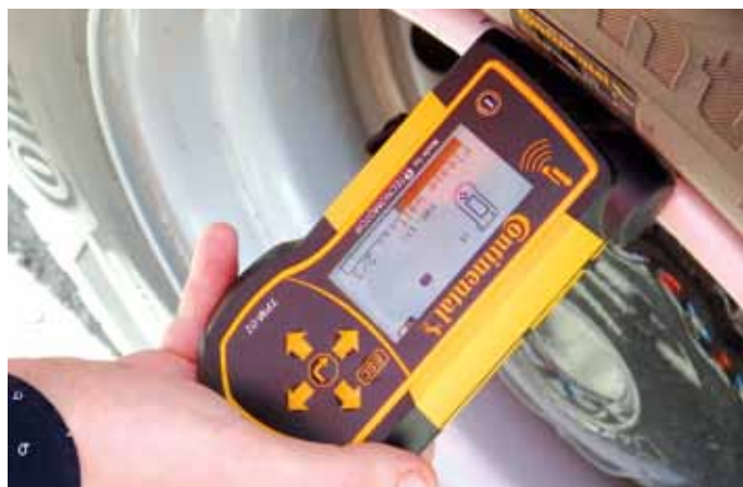
ContiPressureCheck – ročno merjenje tlaka v pnevmatikah.
