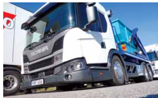
Ko voznik ustavi in sproži samodejno aktiviranje parkirne zavore se kabina spusti in približa tloraj na le 13 cm.
