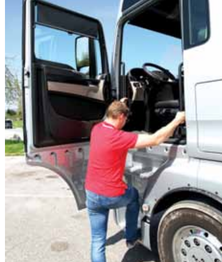
Razdalja od tal do spodnje stopnice je približno 370 milimetrov.
