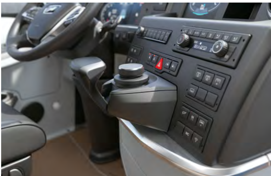
Vrtljiv gumb SmartSelect z naslonom za roko omogoča preprosto upravljanje s funkcijami infotainment sistema.
