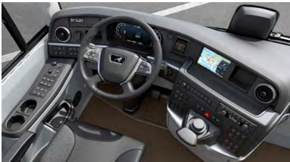
Nova armaturna plošča povečuje udobje za voznika, poleg dveh LCD zaslonov in nove krmilne enote klimatskega sistema, je povečano tudi število odlagalnih površin.
