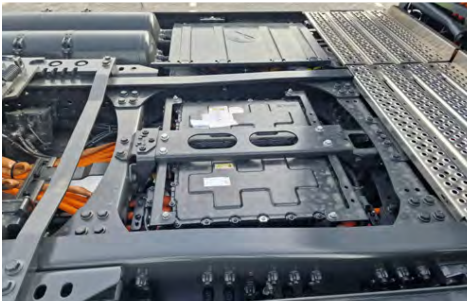
Po en paket baterij je na levem in desnem boku, tretji pa je nameščen v sredini šasije, saj tam ni več kardanskega prenosa ter menjalnika.
