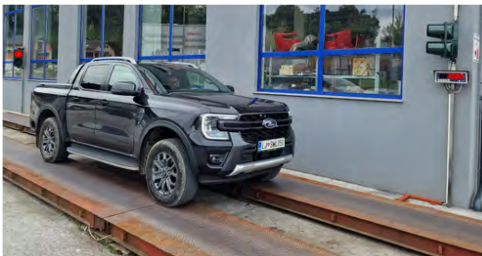
Vsa vozila smo po natovarjanju tudi stehali in tako zagotovili zelo enakomerno obremenitev ter s tem primerljive pogoje za vzporedni test.
