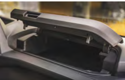
Vgradnja zračne blazine v strop je sprostila prostor za velik predal v armaturi.
