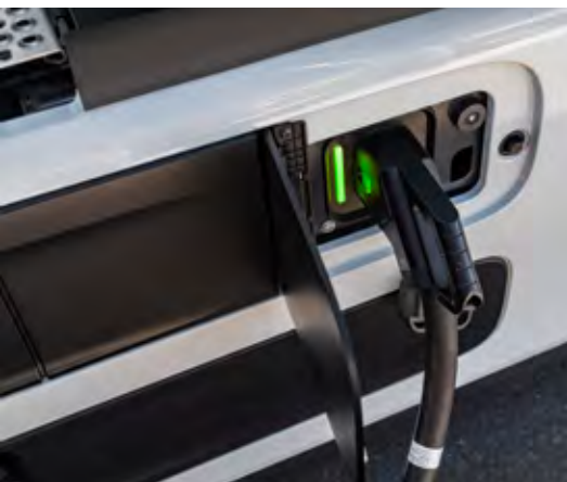
Priključek za polnjenje baterij je na levem boku, opcijsko pa ga bo mogoče dodati tudi na desni strani.
