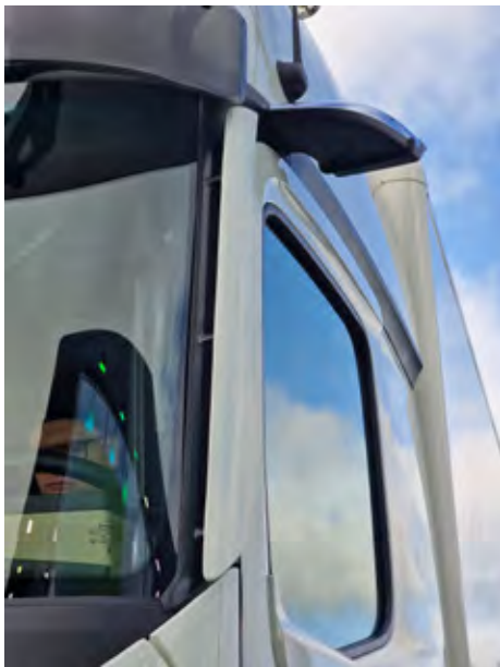
Novost je aerodinamični usmerjevalec zraka na A stebričku.
