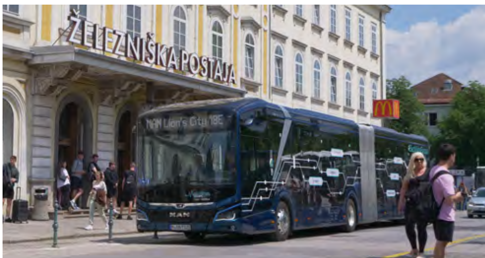
Na, za mestni avtobus netipični, 1.255 kilometrov dolgi poti, je bila povprečna poraba elektrike le 0,71 kWh/kilometer.
