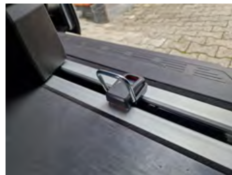
V vzdolžne tirnice je moč namestiti zanke za varno pritrjevanje tovora.
