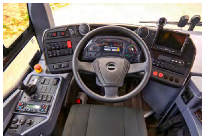
Osrednji del armaturne plošče se nastavlja skupaj z volanskim obročem.
