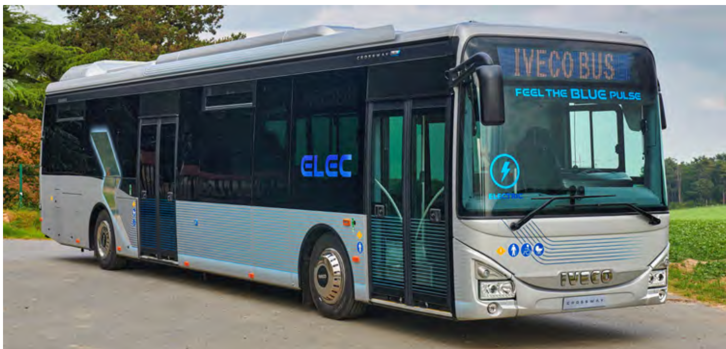
Električni linijski avtobus Crossway LE Elec z nizkopodnim vstopom ponuja doseg okoli štiristo kilometrov ter je na voljo v dolžini 12 in 13 metrov.
