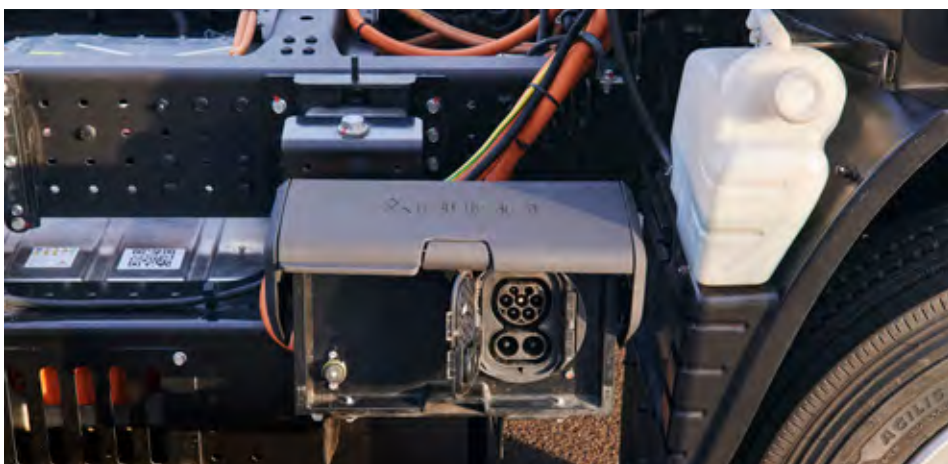
Priključek za polnjenje baterij je na desnem boku, polnjenje pa je mogoče z največjo močjo 104 kilovate, kar pomeni da so baterije polne v manj kot eni uri.
