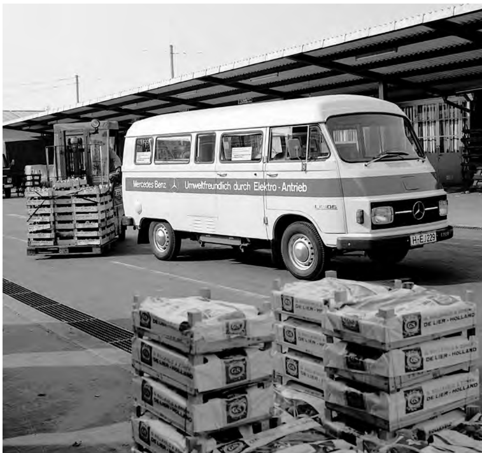
Baterije skupne kapacitete 22 kWh so omogočale doseg med petdeset in sto kilometri, največja hitrost pa je bila omejena na 80 km/h.
