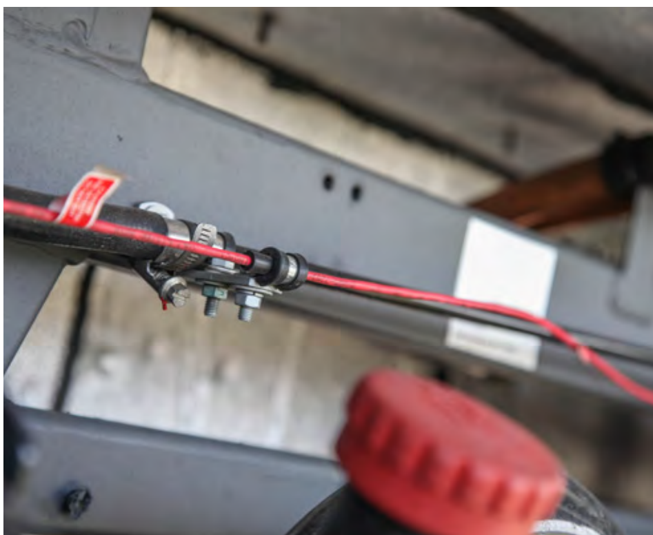
Rdeče obarvana napeljava je senzor ki odkriva prekomerno temperaturo v motornem prostoru in pripomore k hitremu zaznavanju požara.
