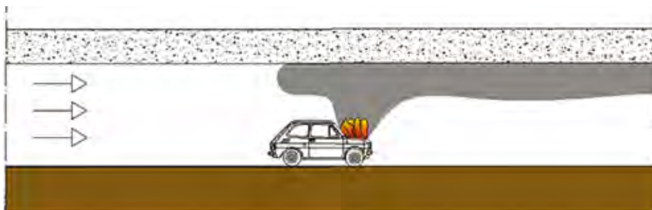
Sistem vzdolžnega prezračevanja v predoru. Cilj je potiskati dim v eno smer (navzdol), tako da zgornji del predora ostane primeren za potnike.
