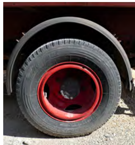
Visoke pnevmatike dimenzij 6.50 R 16 lepo zapolnijo okrogolino blatnika.
