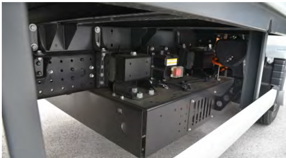
Baterijski paketi so nameščeni v zaščitnih jeklenih ohišjih pod šasijo na sredini vozila, kar pripomore k optimalni razporeditvi mase.
