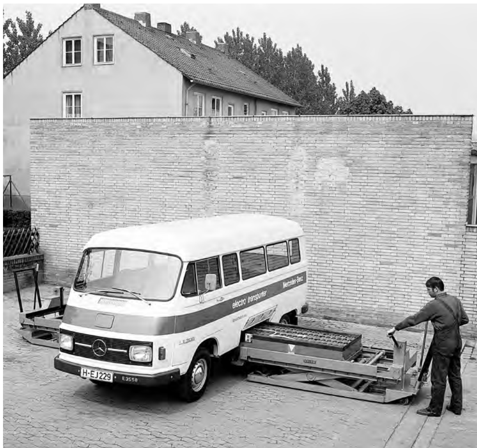
Mercedesov dostavnik je omogočal hitro menjavo baterij - prazne so se na eni strani izvlekle ven, polne pa iz druge strani vstavile v vozilo.
