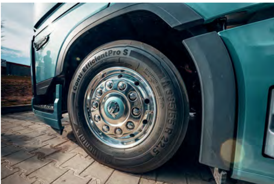
Pnevmatike Continental EfficientPro, z zmanjšanim kotalnim uporom, so idealne za uporabo na električnih tovornjakih, ki večino kilometrov prevozijo po avtocesti.
