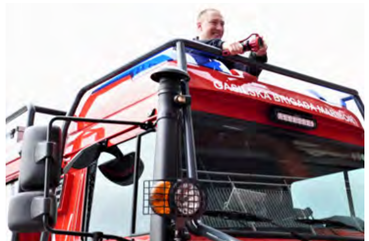
Loputa za gašenje v stropu kabine je s seznama dodatne opreme.
