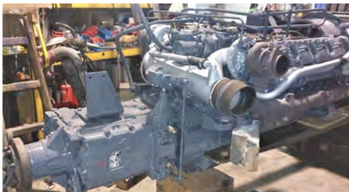
Med zadnjim popravilom so zamenjali sklopko, ob tem pa tudi opravili servis na motorju in ga skupaj z menjalnikom na novo pobarvali.
