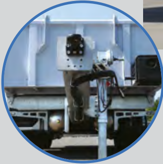
Vroče cinkana šasija in podvozje kesona
